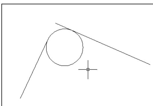
Рисунок 24- Построение окружности по двум точкам касания и радиусу
