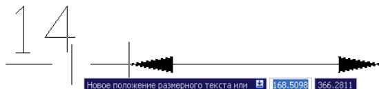
Рисунок 72- Изменение местоположения размерного текста
