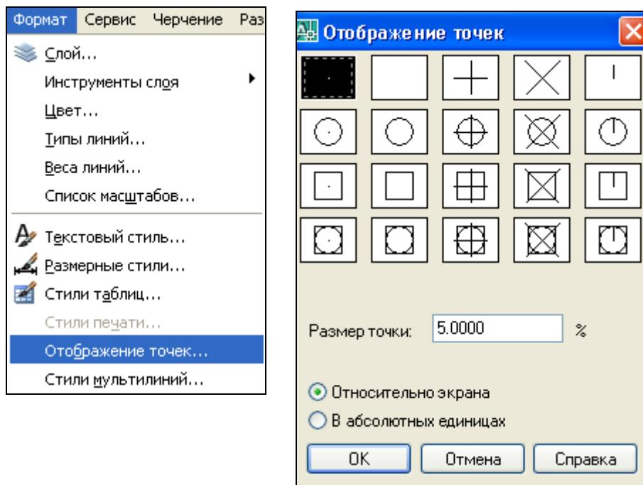
Рисунок 20- Вызов диалогового окна «Отображение точек»
