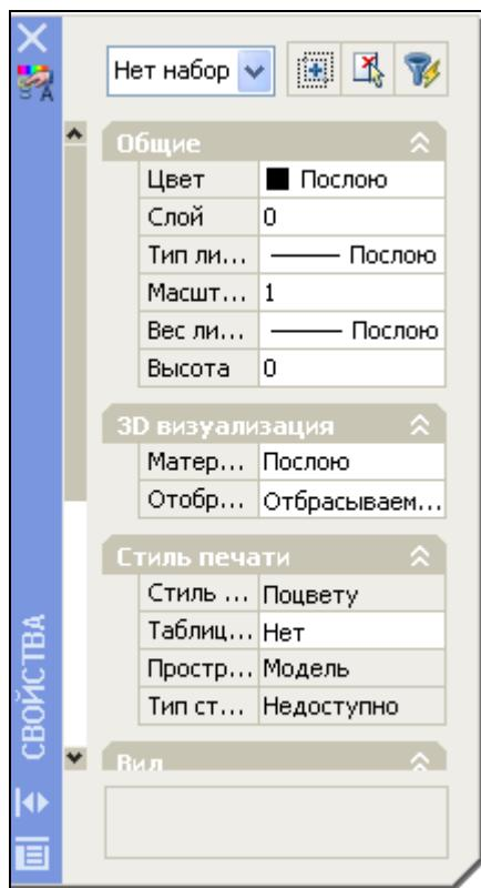
Рисунок 100- Окно «СВОЙСТВА» при отсутствии выбранных объектов
