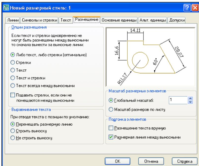
Рисунок 111-Вкладка Размещение диалогового окна «Новый размерный стиль».
