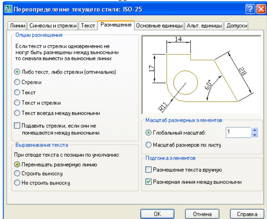
Рисунок 74- Вкладка - Размещение диалогового окна « Переопределение текущего стиля» для изменения глобального масштаба
