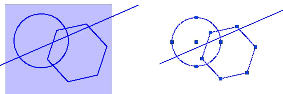
Рисунок 41- Выделение объекта в режиме рамки
