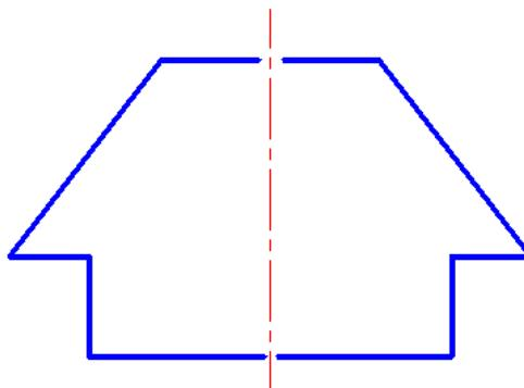
Рисунок 44- Зеркальное отображение объектов
