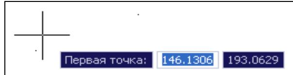
Рисунок 21 Динамическое отслеживание координат курсора
