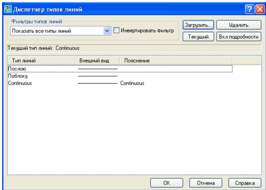
Рисунок 91-Диалоговое окно Диспетчер типов линий
